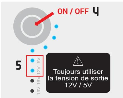
Allumer la batterie par un appui long sur le bouton ON/OFF puis vérifier que la batterie est bien sur la position 12V / 5V. Si ce n'est pas le cas, effectuer 2 appuis brefs sur le bouton afin de changer la tension de sortie. Répéter l'opération jusqu'à atteindre la position 12V / 5V.
