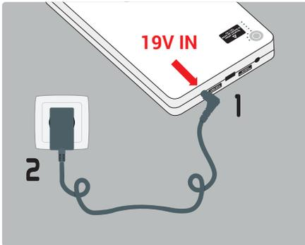
Brancher l'adaptateur standard fourni dans le port « 19V IN » de l'alimentation de la batterie. Brancher la fiche de charge à votre installation électrique.
