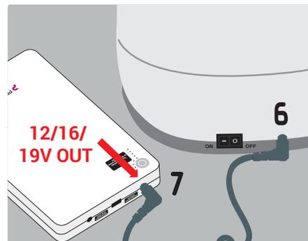
Connecter le système C2S Pro à la batterie avec le câble fourni. Brancher ensuite le câble à la batterie sur la sortie « 12/16/19V OUT ». **Le système C2S Pro est désormais autonome.**
